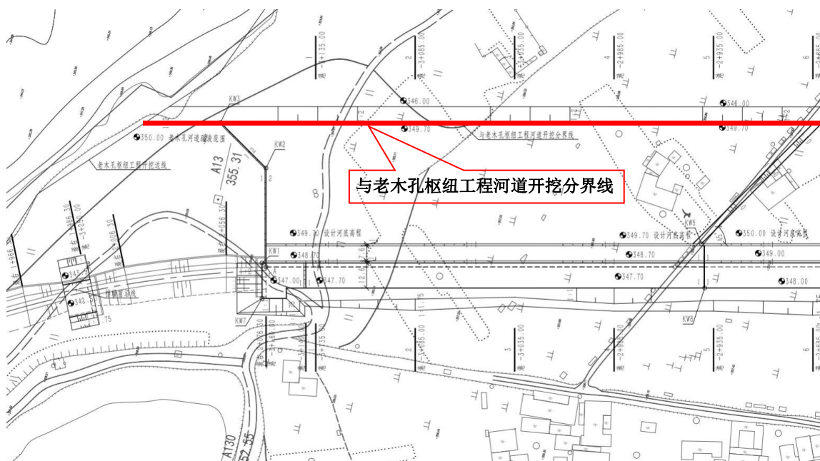
图 2.9-5 码头前沿与老木孔枢纽开挖分界图
